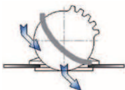
Chladicí spád - vnější točivost vertikální směr proudění
